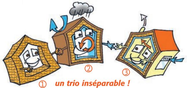
❖ Pour qu'un isolant isole bien, il faut le mettre à l'abri des courants d'air et de l'humidité : c'est le rôle du pare-vapeur (ou freine-vapeur) (en bleu sur le dessin) mis en œuvre contre l'isolant du côté intérieur des parois et celui du pare-pluie (ou sous-toiture) (en brun sur le dessin) posé contre l'isolant du côté extérieur.
